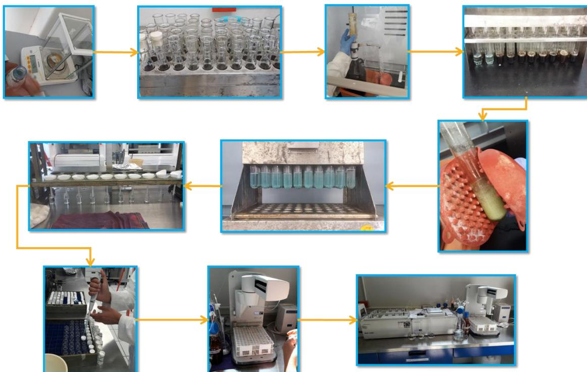
Figura 7. Preparación de diluciones para análisis en el colorímetro
