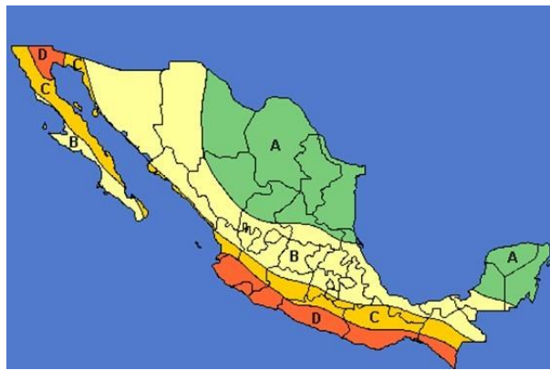
Fig. IV. 1 Zonificación sísmica de acuerdo con la CFE
