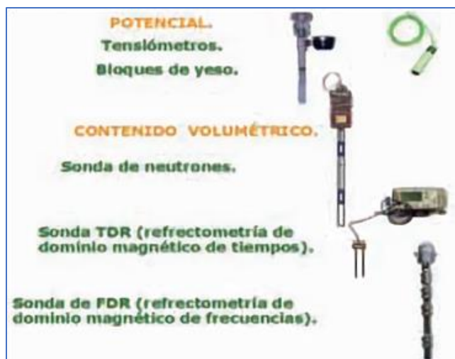
Figura 6.7. Distintos tipos de sensores de humedad en suelo
