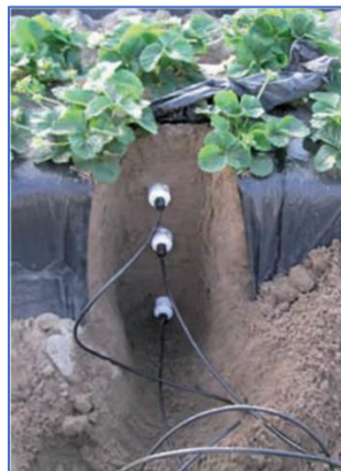
Figura 6.8. Sensores de humedad instalados en cultivo de fresa
