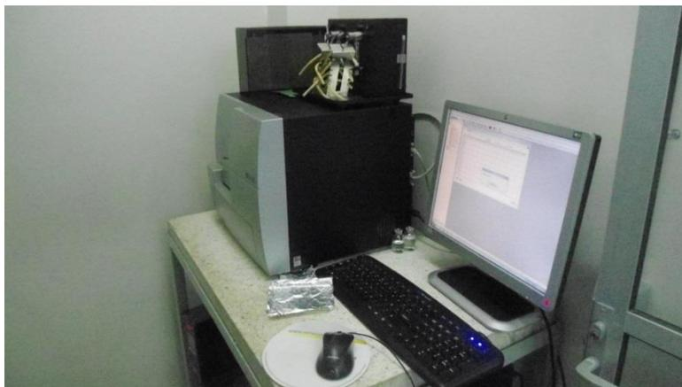
Figura 32. Lector de microplacas con dispensadores automáticos marca BIo Tek modelo Synergy.
