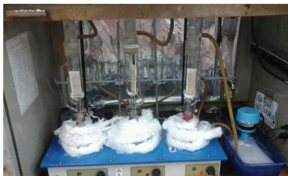
Figura 30. Equipo de soxhlet
