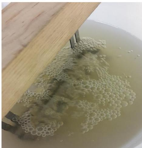
**Figura 4. 25.** Retro lavado del módulo de filtración por medio de aireación a 30 L/h por un minuto.
