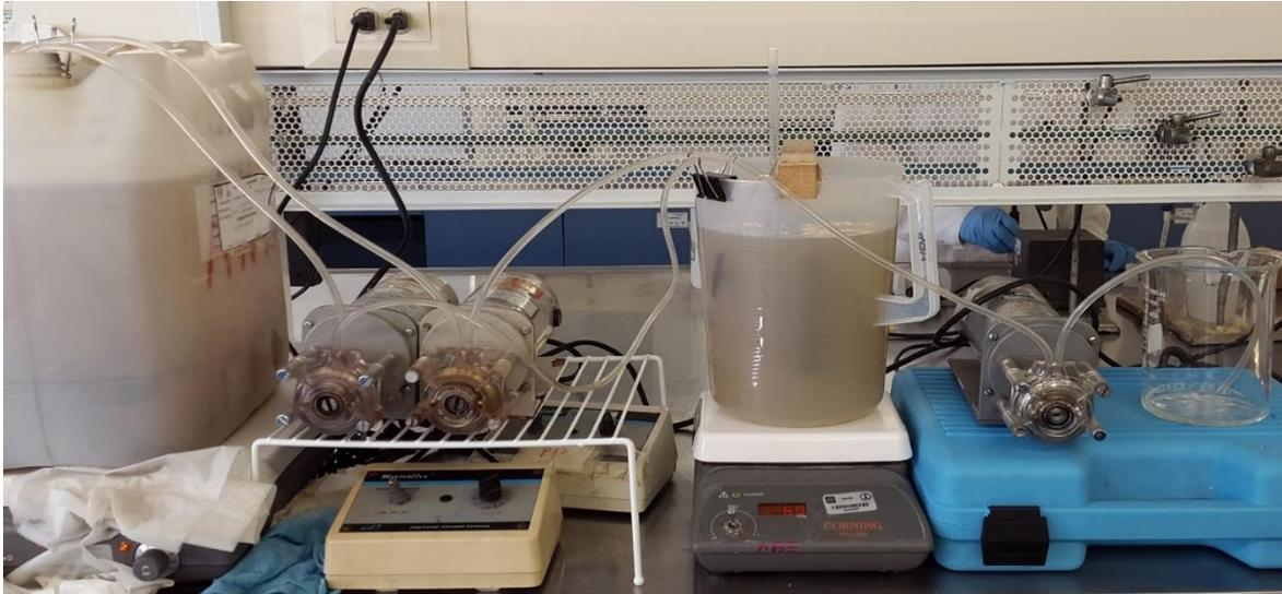
**Figura 3. 3.** Sistema de filtración de efluente anaerobio mediante una MDP de moringa.
