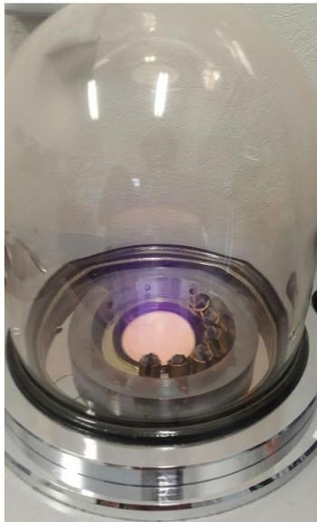
**Figura 3. 8.** Recubrimiento con oro. Preparación de muestras textiles para observación en SEM.
