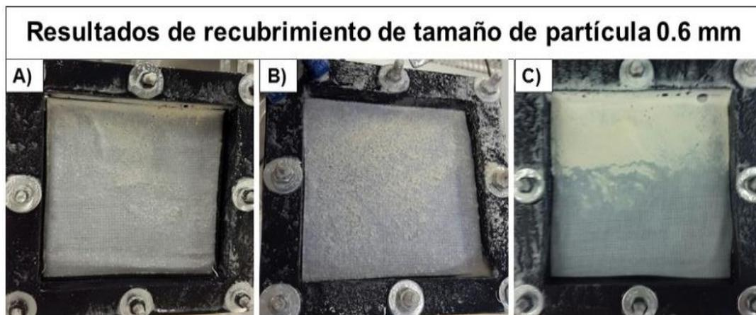
**Figura 4. 6.** Fotografías del módulo de filtración (con salida de permeado en la parte de arriba posterior de cada imagen) después de un recubrimiento de suspensión de semilla de moringa de 0.6 mm de tamaño de partícula y dosis de 2 g/L a diferentes condiciones: A) 90 grados utilizando agua destilada como medio, B) 65 grados de inclinación con agua de la llave, C) 90 grados de inclinación con agua de la llave.
