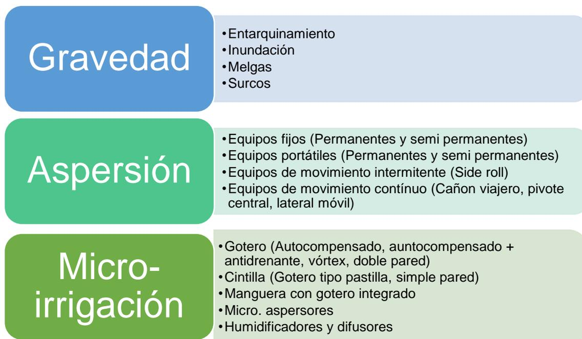
Figura 1. Clasificación de los sistemas de riego
