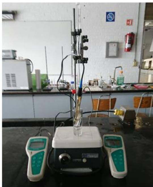
Figura 4.3 Fotografía del montaje utilizado para realizar las valoraciones ácido base empleando el electrodo comercial y el electrodo alternativo POSAI-POSAL.
