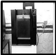
2) Precalear la preforma de la sal de grano a una  $T=200^{\circ}\text{C}$  durante 15 minutos, si se utiliza sal fina no se efectuará el precalentamiento y para el caso B una vez efectuada la calcinación continuar con el paso siguiente.
