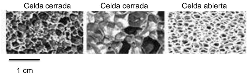
**Figura 1** Tipo de celda para 3 metales celulares comerciales (Alporas, Alulight y ERG).
