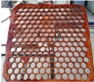
Figura 6.4 Barnizado y Sellado del Mollado
