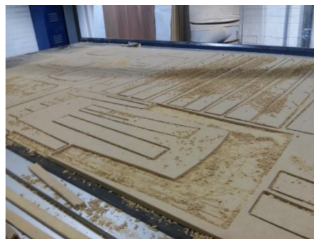
Figura 6.34 Piezas Cortadas en MDF
