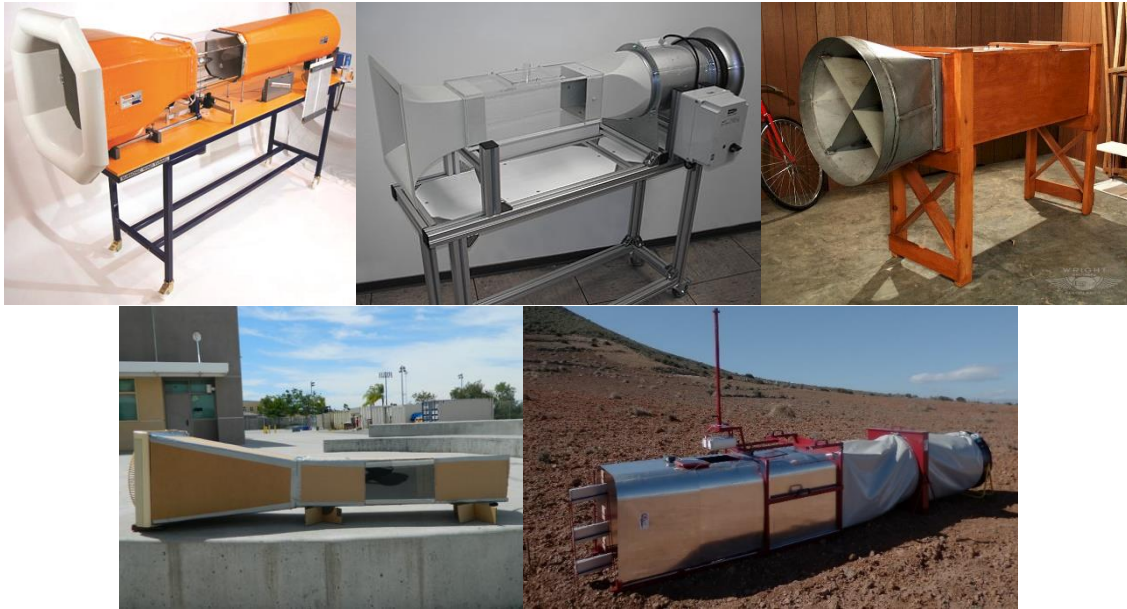
Figura 1.23 Tipos de Materiales de los Túneles de Viento. De Izq. a Der. En la Primer Fila Túnel de Viento de de Acero 42 , Túnel de Viento de Aluminio con Ventilador Centrifugo 43 , Túnel de Viento de Madera 44 y Segunda Fila, Túnel de Viento de Cartón 45 , Túnel de Viento de Aluminio 46
