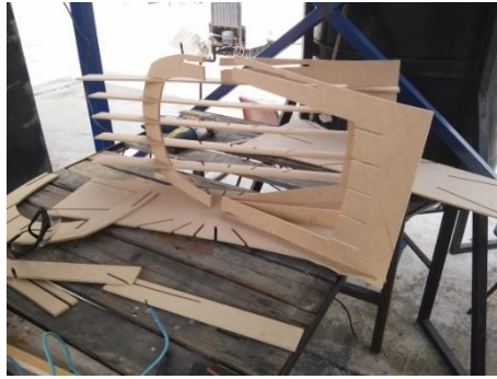
Figura 6.35 Armado del Difusor
