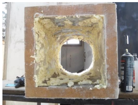
Figura 6.50 Cubriendo los Huecos con Pasta Automotriz y Espuma de Polietileno
