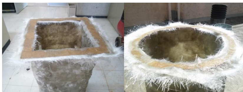
Figura 6.47 MDF con Fibra de Vidrio en Cada Cara
