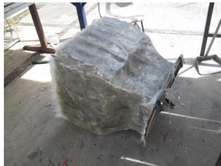
Figura 6.13 Colector Cubierto con Fibra de Vidrio
