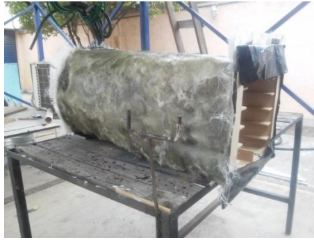
Figura 6.44 Aplicación de Toda la Fibra de Vidrio
