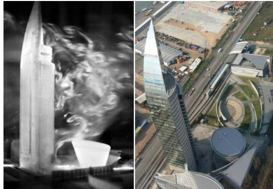
Figura 1.10 Flujo Alrededor de un Edificio 25
