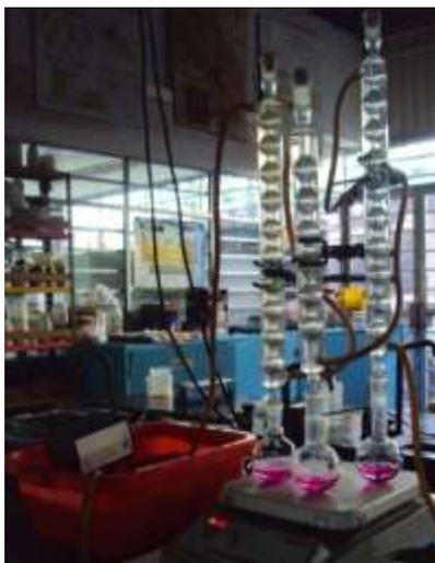
Figura 14. Equipo para la determinación de ésteres.
