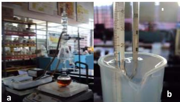
**Figura 12. Material y equipo para la determinación de contenido alcohólico en donde a) Equipo de destilación y b) Lectura de la muestra con el alcoholímetro.**
