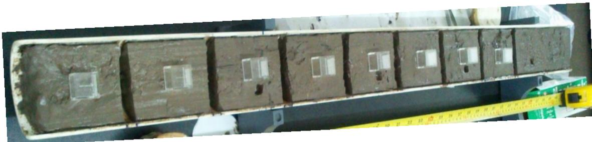
Figura 4.2. Se observa la mitad de una sección del núcleo. También se observan los cubos de 8 cm<sup>3</sup> con los cuales se obtuvieron las muestras discretas.
