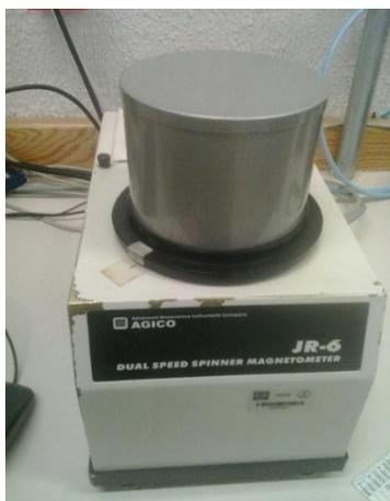
Figura 4.4 Magnetómetro de giro AGICO JR-6.
