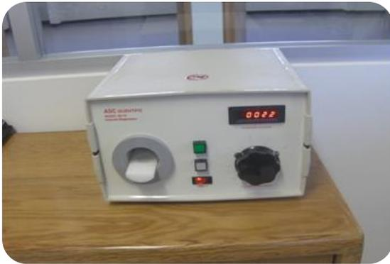
Figura 4.7 Magnetizador de pulsos -ASC SCIENTIFIC, modelo IM-10.
