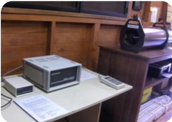
Figura 4.5 Desmagnetizador de campos alternos AGICO LDA3.
