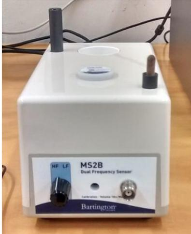
Figura 4.3 Equipo donde se realizó la medición de la susceptibilidad a baja y alta frecuencia. Sensor de frecuencia dual Bartington MS2B.
