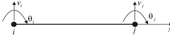
Figura 27. Elemento finito tipo viga.
