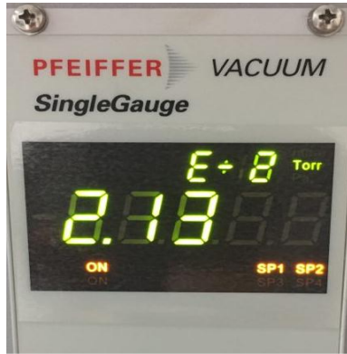
Figura 9. Barómetro digital del equipo (pre-vacío con bomba mecánica).
