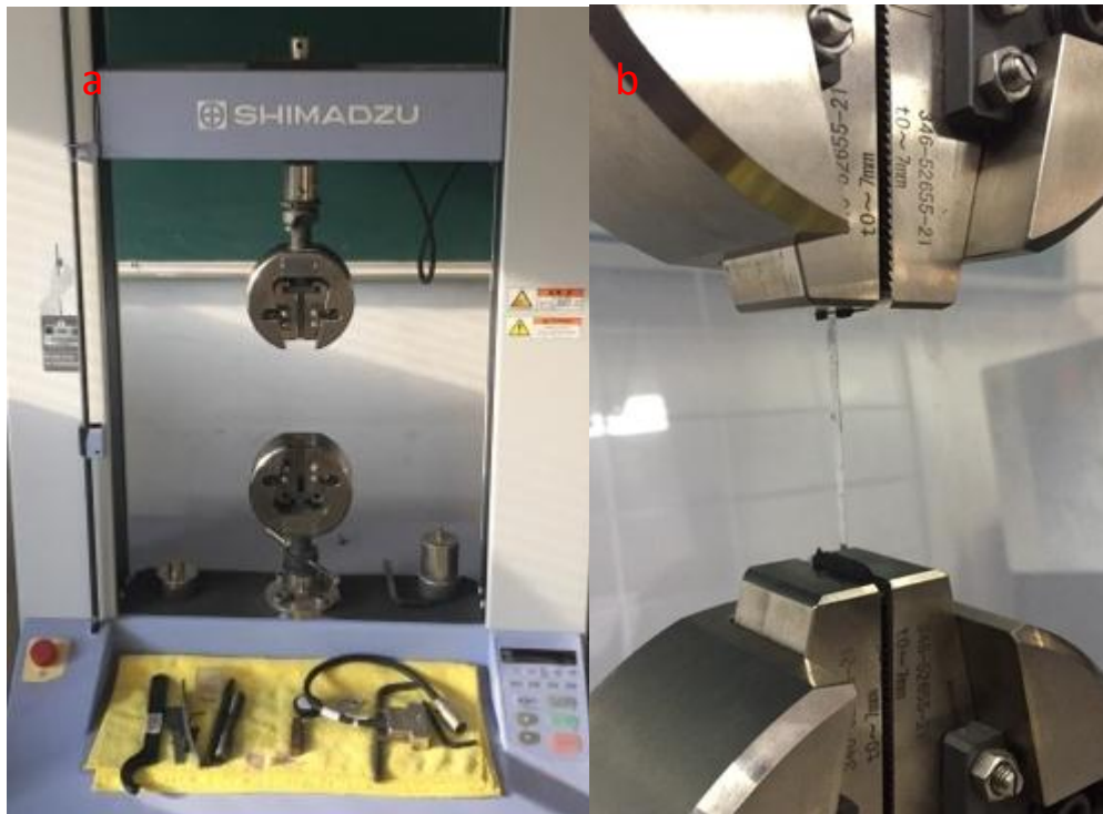
Figura 22. a) Equipo donde se llevó a cabo el ensayo de tracción a las cintas metálicas. b) Cinta metálica montada.
