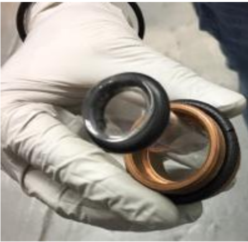
Figura 15. Crisol de sílice ( \text{SiO}_2 ) donde se deposita la aleación fracturada.
