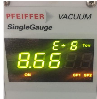
Figura 10. Barómetro digital del equipo (vacío con bomba difusora).
