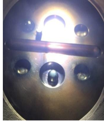
Figura 13. Cámara del horno eléctrico de arco. Se observa una sola aleación al centro, Ni-Nb-Zr-Ti-Cu, después de fundir los lingotes de la figura 12.
