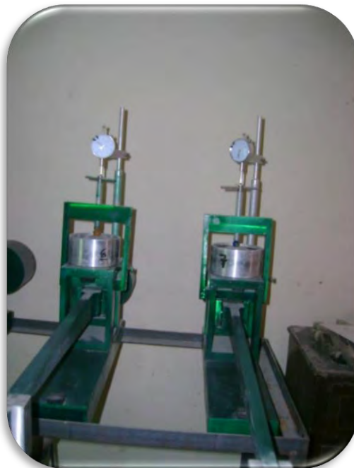
Prueba de consolidación
