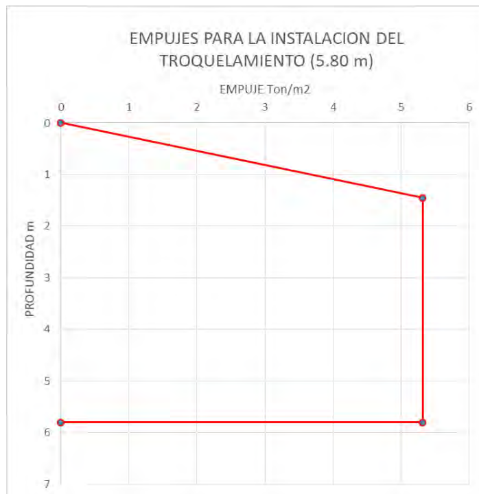
Figura 17.5 Empuje para instalación de troquelamiento (5.8m) SC. 3.0 Ton/m 2
