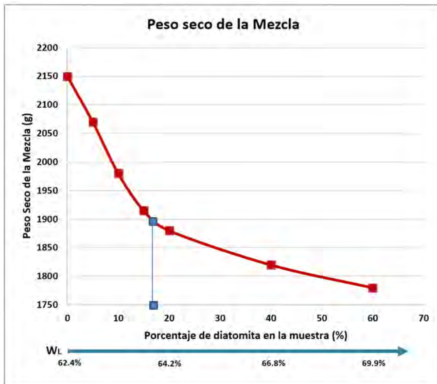
Figura 3.4.1 Peso de la mezcla en seco con respecto al aumento de diatomita
