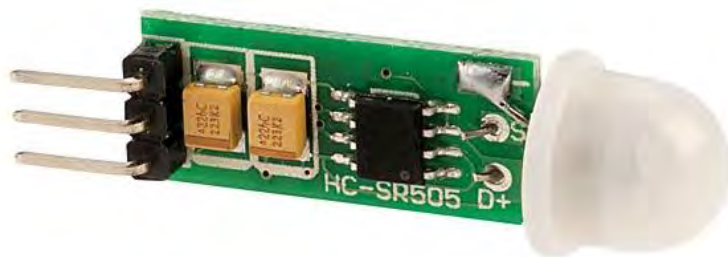
Figura 42 Sensor infrarrojo de movimiento HC-SR505 Mini, (Sigma Electrónica LTDA, 2018)
