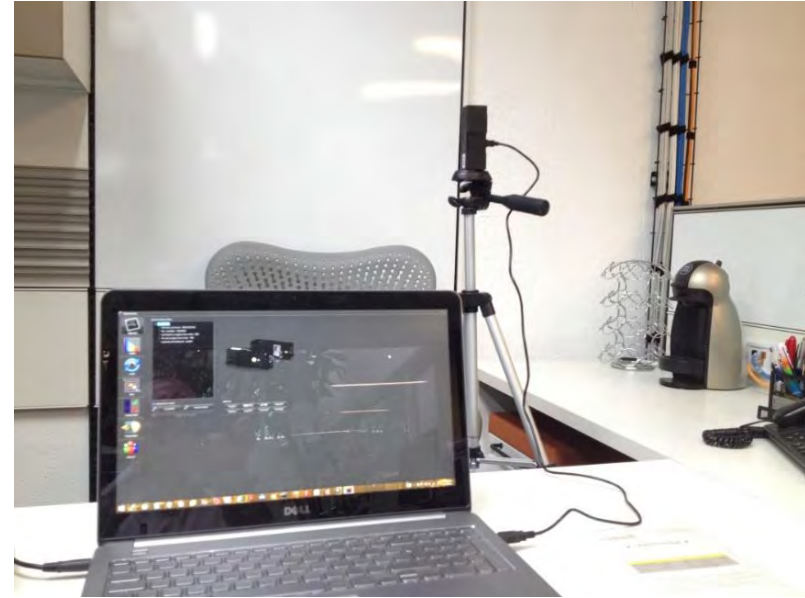
Figura 51 Mediciones en campo con fotospectrómetro portátil. Elaboración propia.
