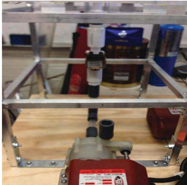
*Fig. 30 Montaje de bomba con tubería. Desarrollo propio.*
