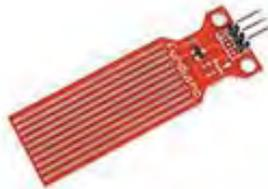
*Fig. 20 Sensor de nivel de agua. Recuperado de <https://www.prometec.net/sensor-agua/>*
