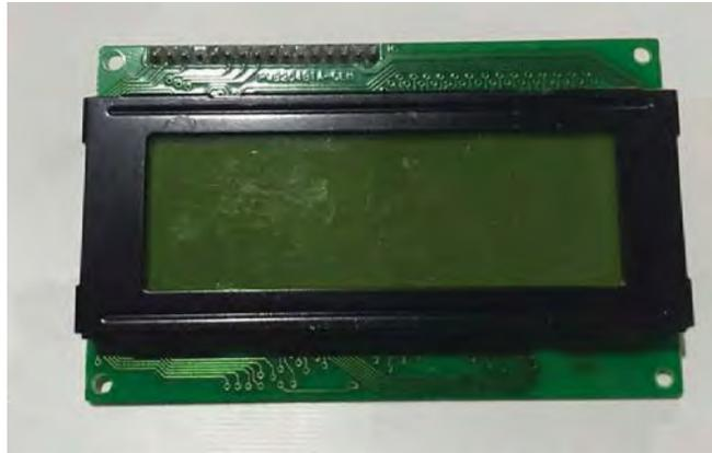
Fig. 18 Display parte frontal. Recuperada de: Hetpro Herramientas tecnológicas profesionales. (2018), PANTALLA LCD 20X4 CON I2C JHD-204A, obtenida de: <https://hetpro-store.com/pantalla-lcd-20x4-i2c-jhd-204a/>
