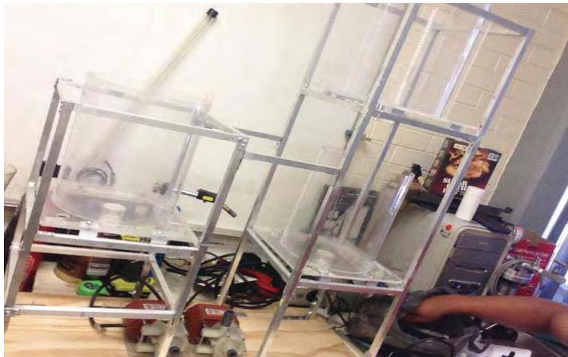
*Fig. 29 Tanques fijados a la base. Desarrollo propio.*
