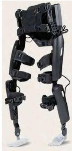
Figura 19. Exoesqueleto REWALK orientado a pacientes con problemas motrices [10].
