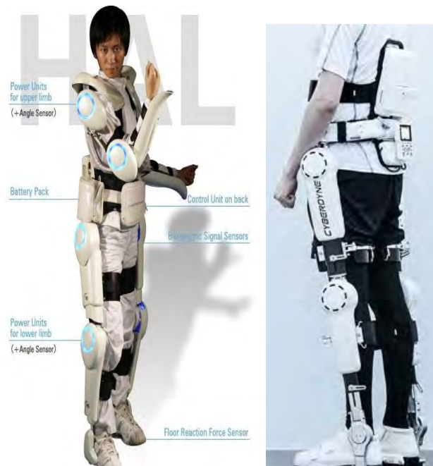
Figura 18. Exoesqueleto HAL y HAL 5 disponible en el mercado [9].
