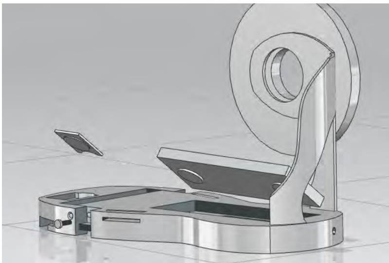
Figura 45. Imagen del modelo seleccionado, en la parte trasera se aprecia la perforación para el cableado de los sensores.
