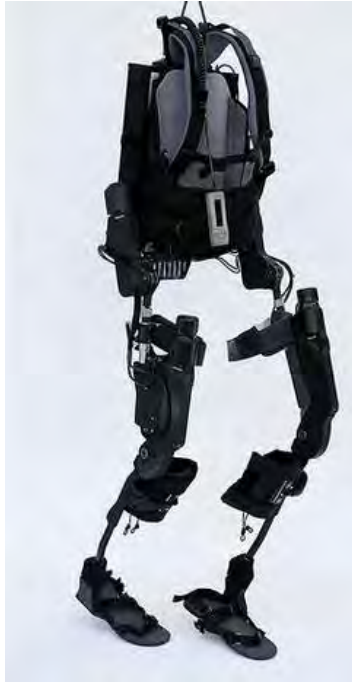
Figura 21. El exoesqueleto eLEGS se controla con base en sensores de presión, prediciendo la intención del paciente [12].
