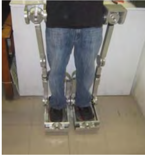
Figura 22. Exoesqueleto OAMI de la Facultad de Ingeniería de la UNAM [13].
