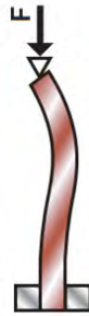
Figura 46. Análisis de una columna al aplicarle una carga crítica y que presenta pandeo [15].
