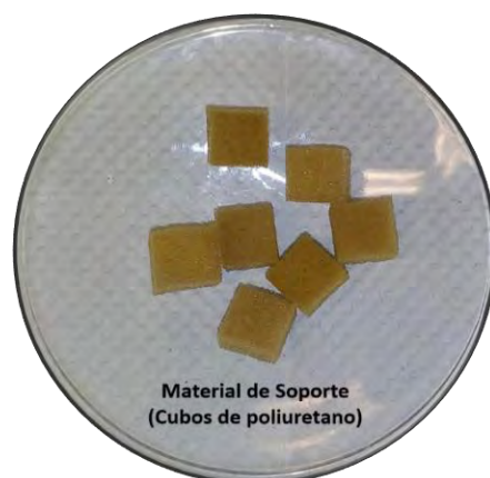
Figura 5.4. Material de soporte, cubos de poliuretano de 1 \text{ cm}^3 .
