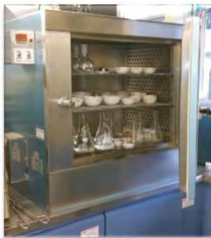
Figura A4. Estufa Digital. Riossa modelo HCF-62.
