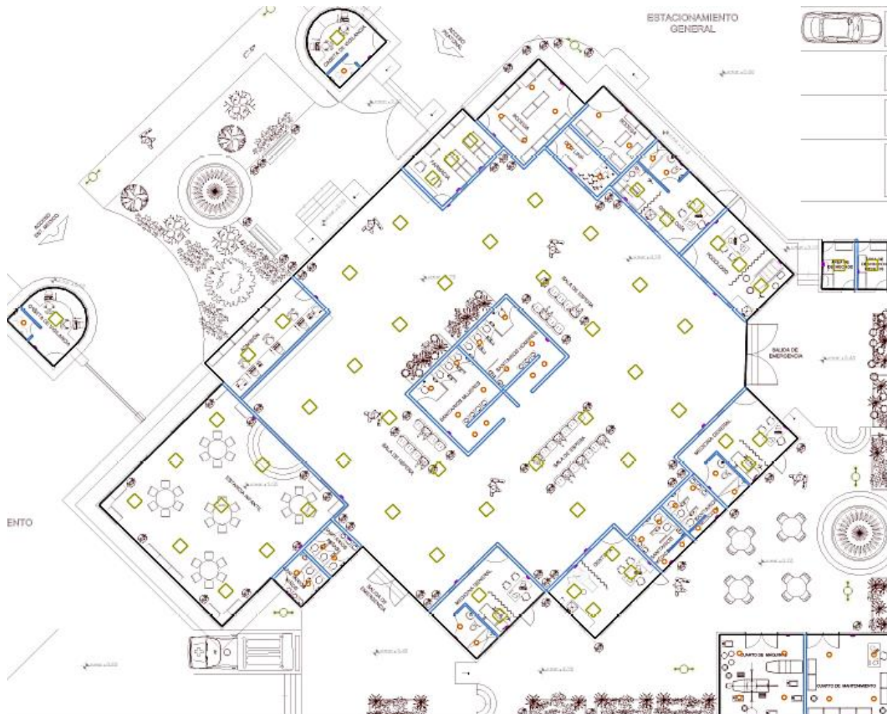
Figura 53. Distribución De Luminarias UMF.
