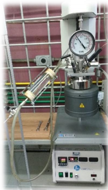
Figura 29. Fotografía del sistema de reacción utilizado en HID de naftaleno y HDO de anisol.
