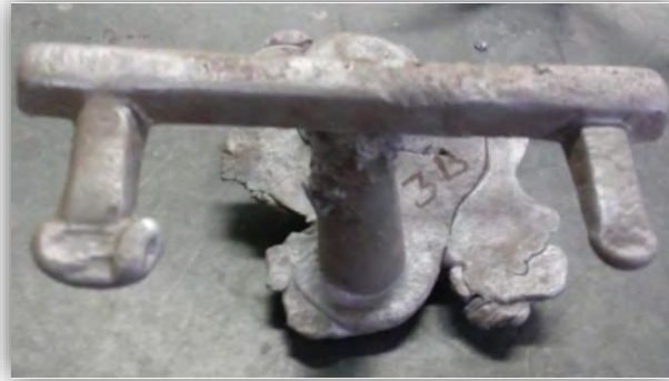
Figura 34 No hubo llenado completo. Pieza 3B
