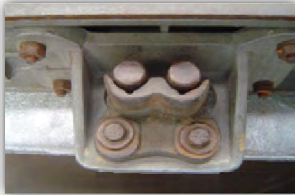
Figura 22 Guía de ensamble de caja de moldeo.
