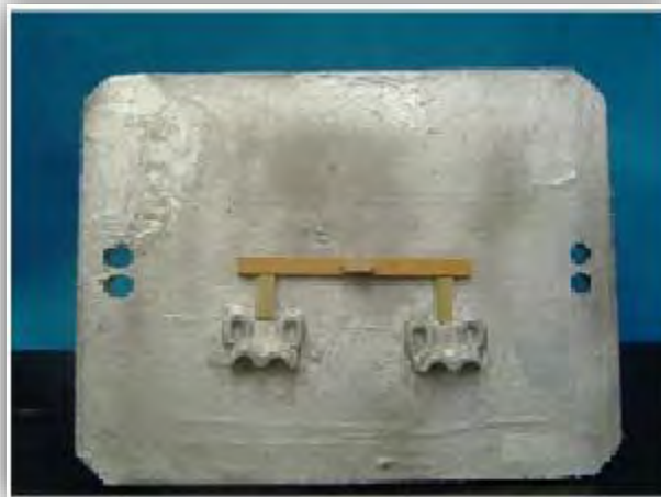
Figura 29 Placa modelo mostrando las dos guías de ensamble, también llamado drag(6).
