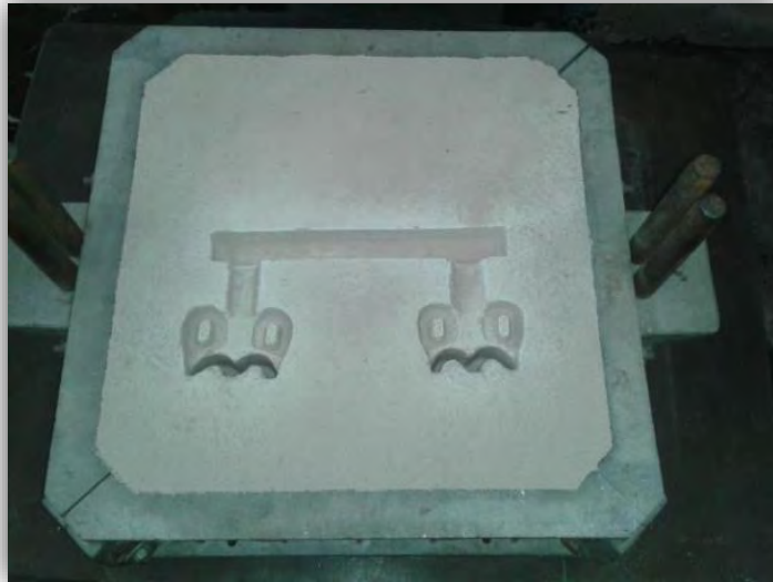
Figura 30 Molde inferior de arena.
