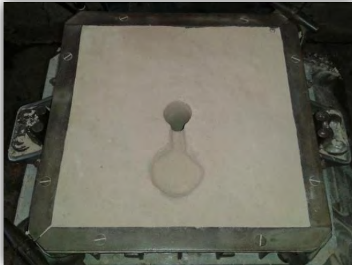
Figura 31 Molde superior de arena.
