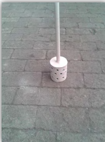
Figura 26 Campana para la introducción de Mg al líquido.
