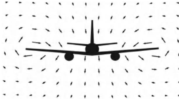
**Figura 2.8:** Campo de velocidad alrededor de una aeronave, vista de un plano  $yz$ [62].
