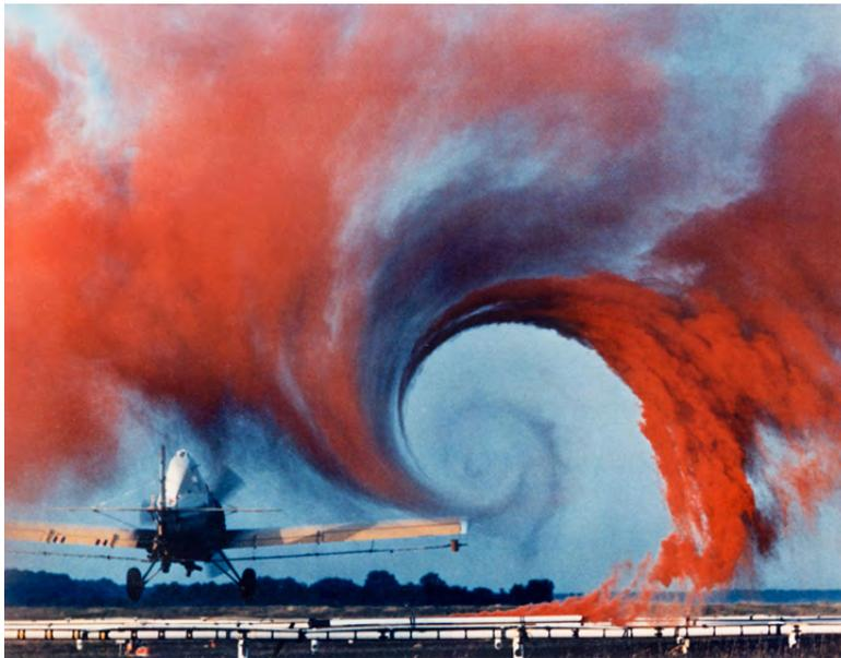
**Figura 1.1:** Vórtice generado en la punta de un ala (NASA).
