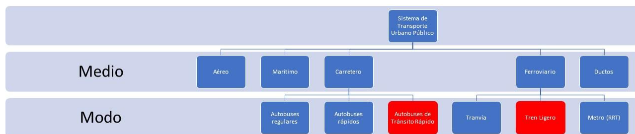
Figura 3 Clasificación general del Sistema de Transporte Urbano Público. Fuente: Elaboración propia con datos obtenidos de: Vuchic, V. 2017
