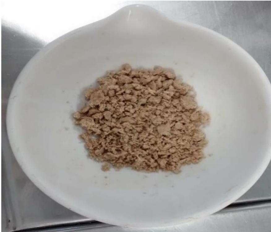
Figura 14. Celulosa de pinzote centrifugada y seca. Fuente: realización propia.
