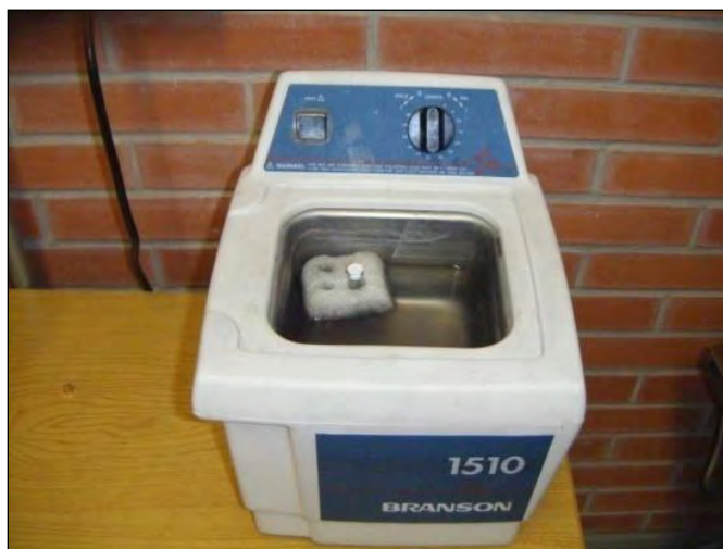
Figura 12.- Tratamiento de mezclado para homogenización en baño ultrasónico
