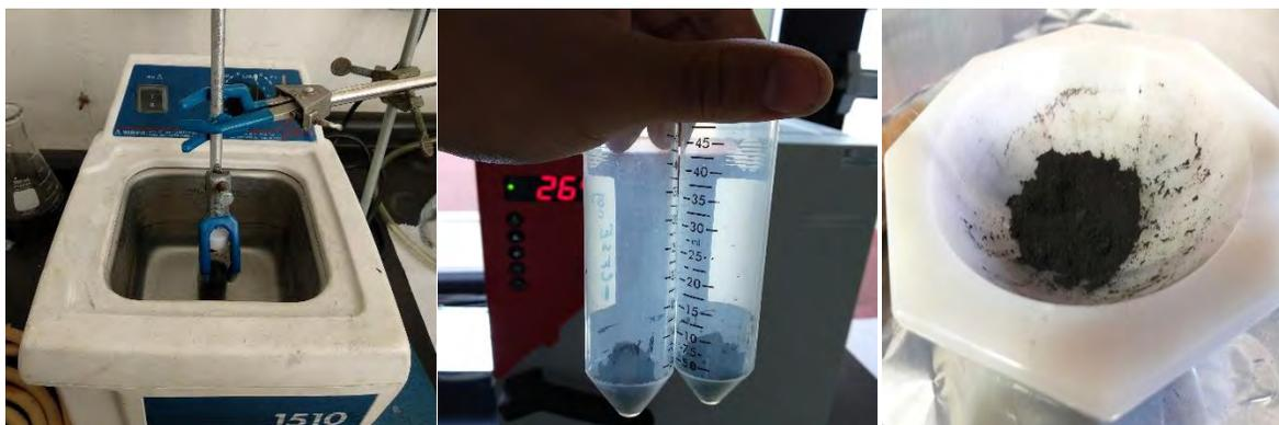
Figura 5.2 Proceso de exfoliación GO: sonicación, secado, trituración.
