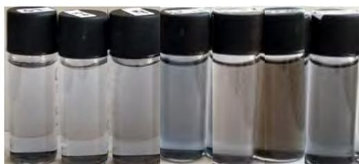
Figura 5.4 Dispersiones (0.25 mg/ml) del precursor GO y los materiales FSI a FSVI obtenidos mediante los ensayos de fragmentación, en orden de izquierda a derecha.
