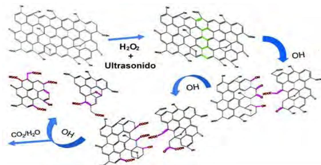
Figura 4.8 Diagrama del mecanismo de fragmentación de láminas de óxido de grafeno en nanoláminas y QDs. [Adaptada de: Jiawei, Materialstoday Communication, 2016]
