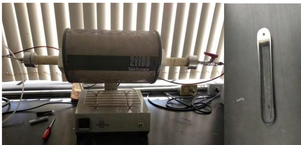
Figura 5.5 Equipo utilizado en los procesos de calcinación: horno tubular (izquierda) y porta muestra cerámico para calcinación (derecha).
