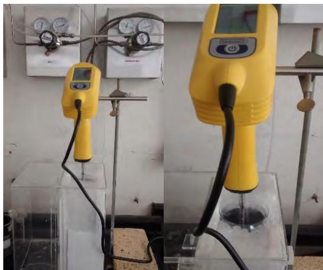
Figura 5.3 Sistema de fragmentación de láminas de GO.
