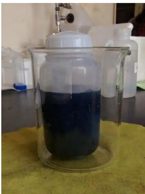
Figura 5.6 Sistema NGO-TiO<sub>2</sub>: óxido de grafeno fragmentado (FSIV) y TiO<sub>2</sub> dispersos en solución metanol/H<sub>2</sub>O previo al proceso solvotérmal.
