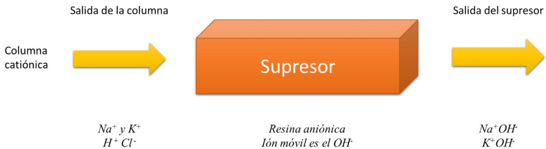
Figura 10 Supresor químico con una columna de neutralización
