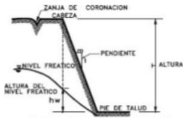
Figura 1.1 Partes de un talud
