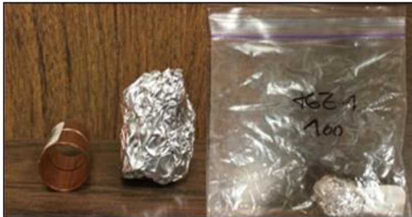
Fig. 3.2 Tubos de cobre utilizados durante el muestreo, en la imagen se puede observar la forma en la que se guardaron y etiquetaron todas las muestras.
