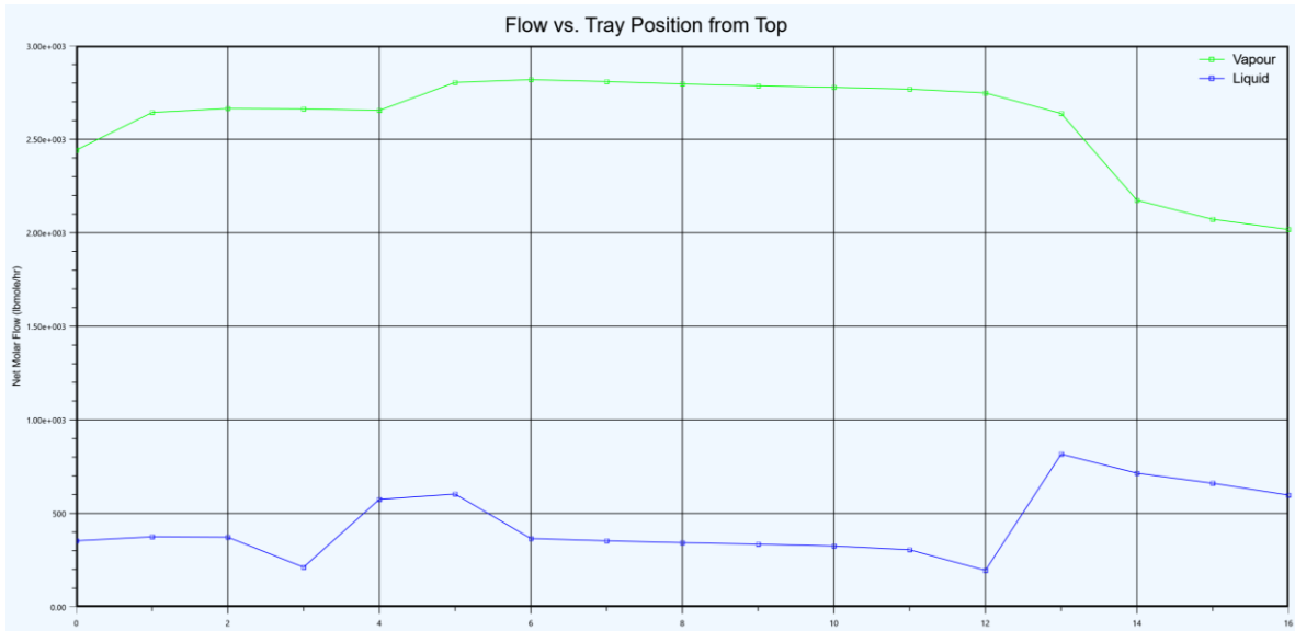
Figura 56. Gráfica de Flujo contra Platos para la Torre de Vacío.
