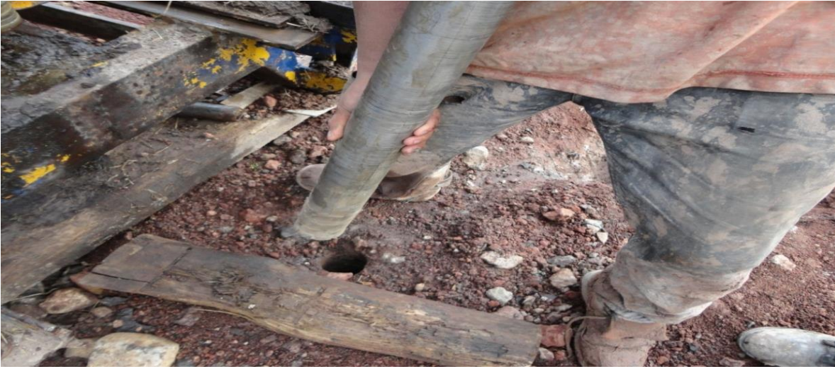
b) Detalle del barreno utilizado para el sondeo S-2
