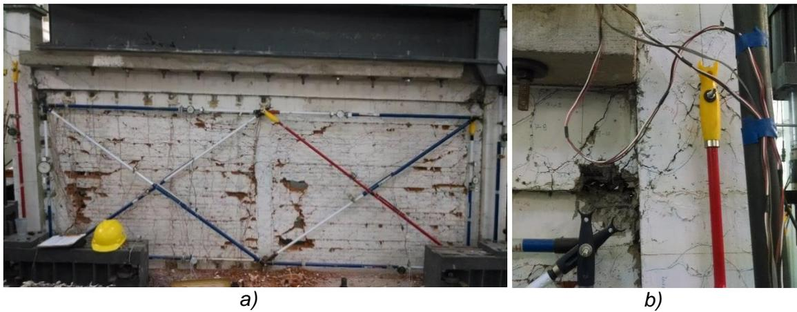
Figura 4.4. Patrón de agrietamiento final del espécimen MD3NRH. a) Agrietamiento en el muro, b) falla en la conexión viga-columna
