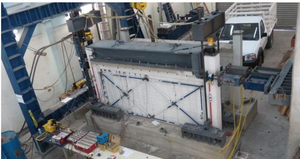
Figura 3.7. Marco de carga completo. a) Diagrama, b) fotografía
