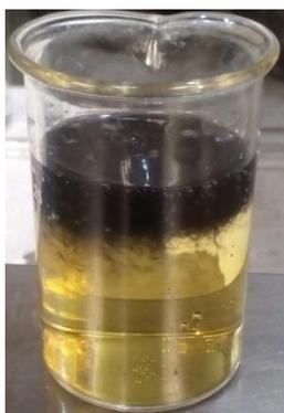
**Figura 12.** Fotografía sólido negro formado al momento de agregar el reductor.
