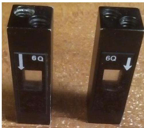
**Figura 21.** Fotografía de las celdas de cuarzo cerradas empleadas.
