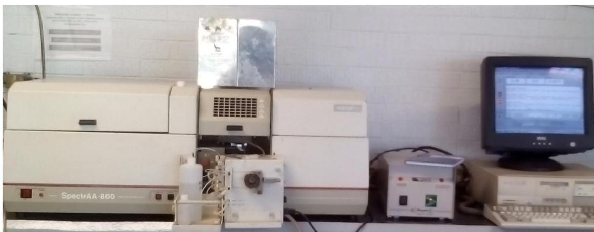
**Figura 1.** Fotografía del espectrofotómetro de absorción atómica con generador de hidruros, modelo SpectrAA-800, Varian, Australia 1995 utilizado.
