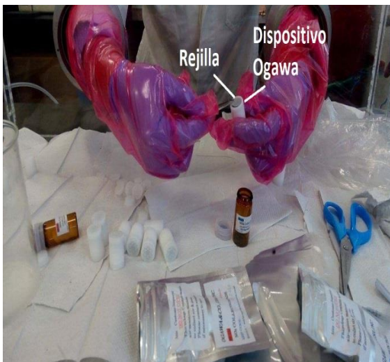
Fig.12 Colocación de rejilla en dispositivo
