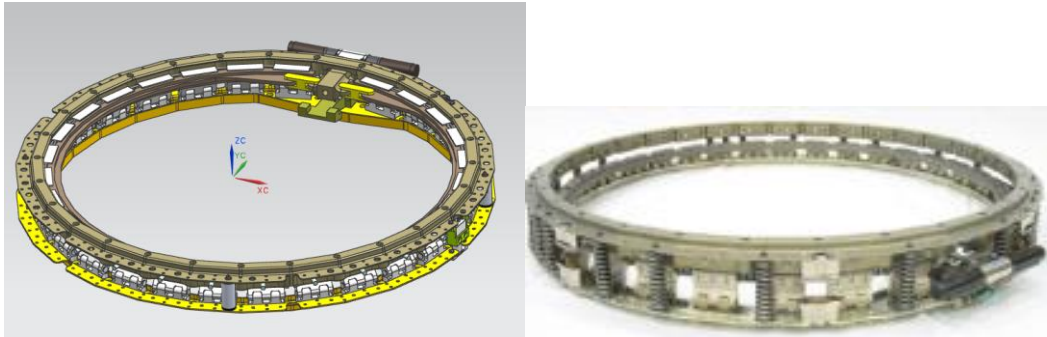
Figura 21 – Sistema de separación MkII the lightband, imagen real y modelo
