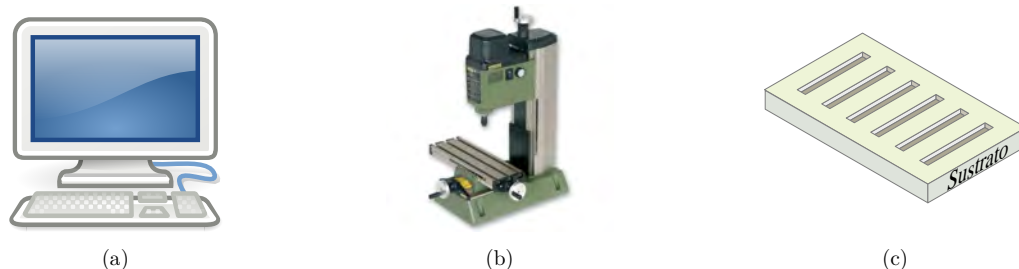
Figura 2.4: Proceso utilizado por el microfresado: (a) diseño en computadora, (b) equipo CNC y (d) sustrato.
