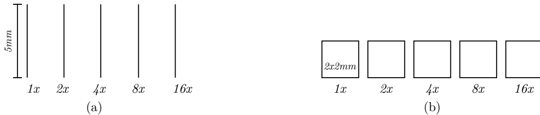
Figura 2.12: Diseño de líneas (a) y cuadros (b), para observar la repetibilidad de un maquinado CNC.
