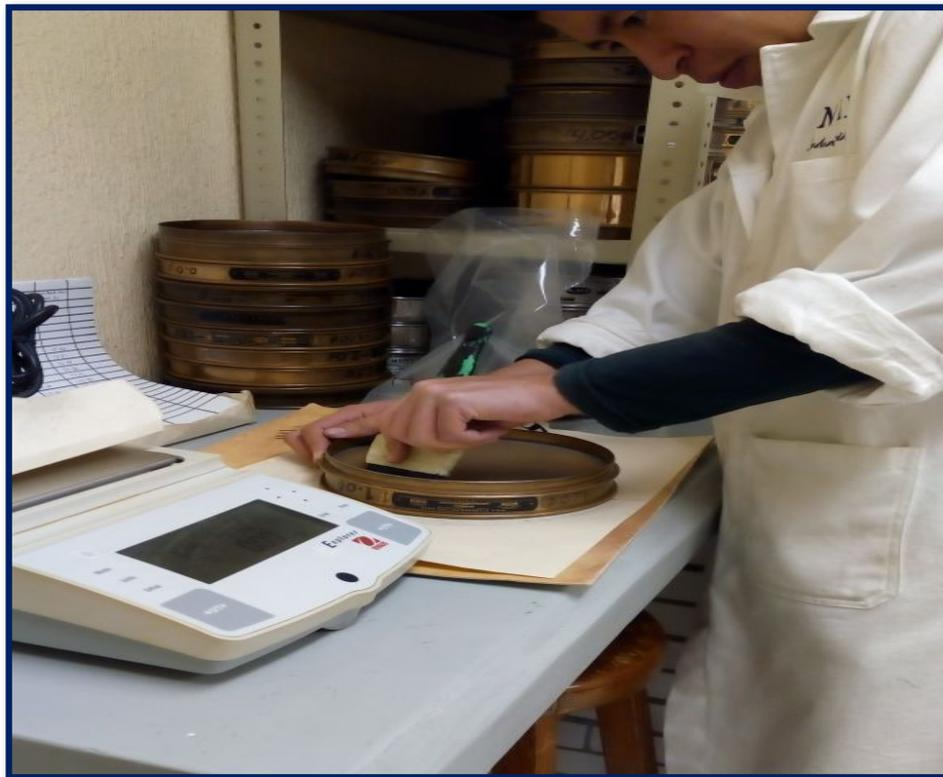
**Figura 29, Proceso de limpieza de los tamices**
