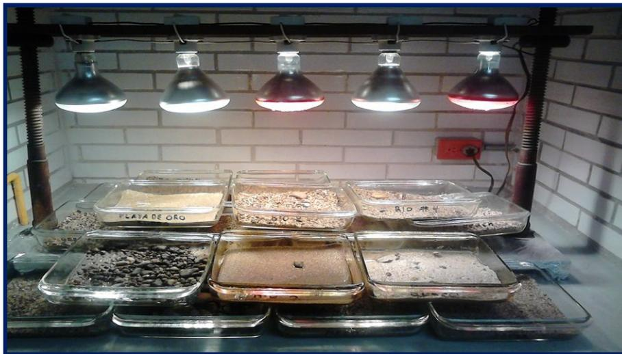
**Figura 27,** Secado de las muestras dentro del horno
