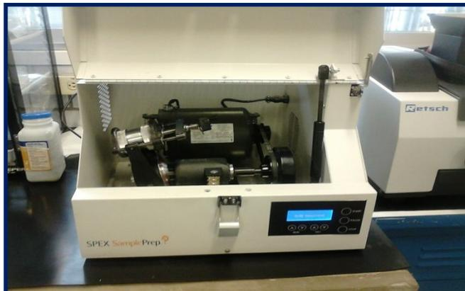
**Figura 56,** Trituradora (modelo SPEX Sample Prep)
