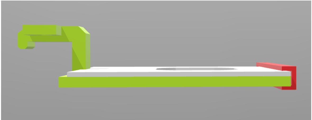
Figura 20. Esquema del soporte completo. Se observan sus tres componentes: base (verde), tapa (blanco) y unión (rojo).
