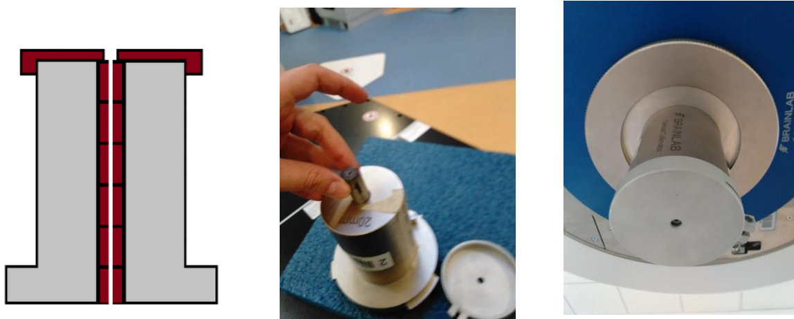
Figura 9. De izquierda a derecha: Esquema de los segmentos del colimador introducidos en el accesorio comercial, foto del método de inserción de los segmentos del colimador dentro del accesorio comercial, y foto del colimador acoplado a la charola de conos del acelerador.
