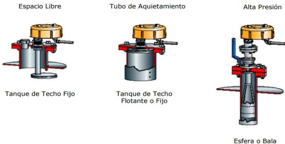
*Fig. 18 Ejemplo de Medición por Radar*
