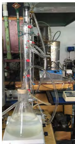
Fig. 6. Instalación del RALLFA a 65°C
