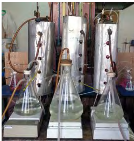
Fig. 3. RALLFA operando a 45, 55 y 65°C, de izquierda a derecha
