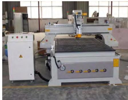
Imagen 8 Ejemplo de Router CNC <sup>36</sup>
