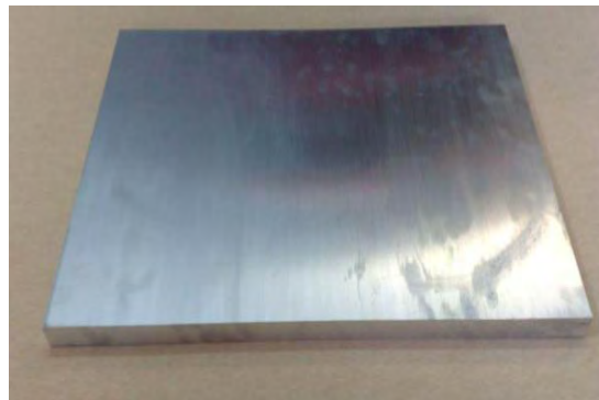
Figura 46. Placa de aluminio ¼ " de espesor.
