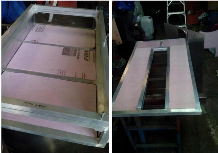
**Figura 21. Instalación del aislante térmico.**
