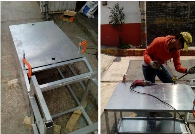
**Figura 20. Ensamble de las distintas caras que componen la cámara de secado, colector y puerta.**
