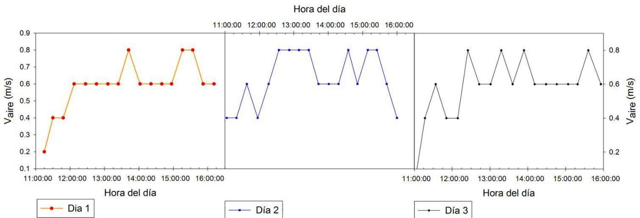
**Figura 28. Velocidad del aire en la cámara de secado en la caracterización del equipo de secado.**
