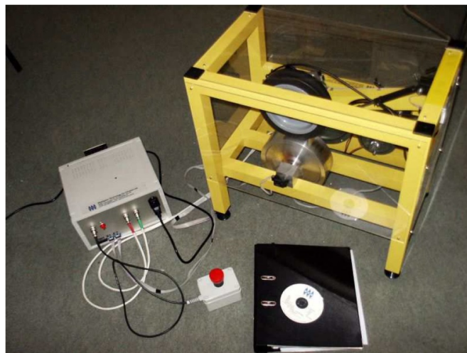
Figura 3.1: Sistema de frenos ABS de Inteco
