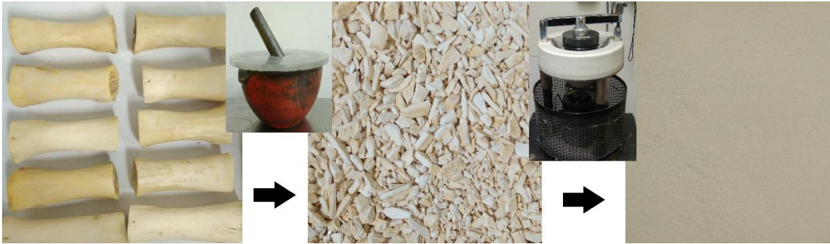
Figura 14 Proceso de molienda. Se trituro con un mortero el hueso y posteriormente con un molino giratorio con anillos de tungsteno para obtener partículas de hueso finas.
