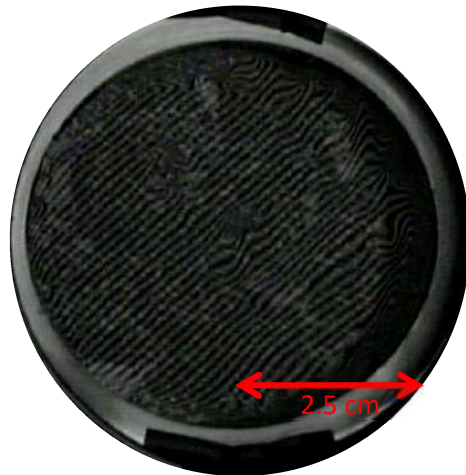
Figura 38. Deposición de desmoldante(D8) sobre el master, examinado mediante deflectometría
