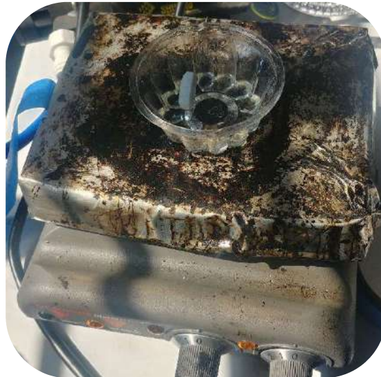
Figura 45. Resina agitándose magnéticamente
