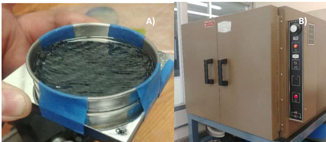
Figura 50. Preparación del prototipo a alta temperatura. A) Anillo con deposición de resina sobre plano \lambda/10 , B) horno de para temperatura.
