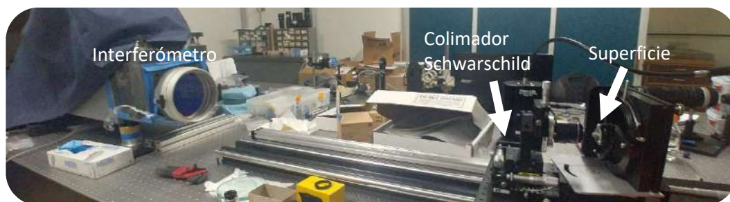
Figura 58. Interferómetro con objetivo de 5" esférico convergiendo a un colimador Schwarzschild, que enfoca a un punto en la superficie a observar.
