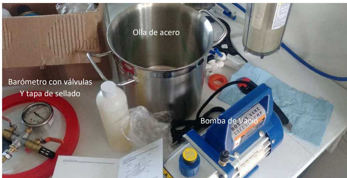
Figura 42. Cámara de vacío con sus accesorios
