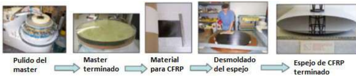
Fig.12 Etapas del proceso de fabricación de espejos de fibra de carbono reforzado, [3-5],[8-9],[45],[50]
