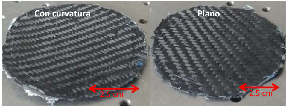
Fig. 32 Resultados de prototipos con una primera capa flexible con forma.
