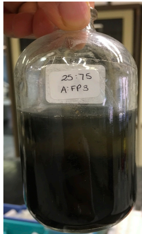
Figura 2.14 y Figura 2.15. Preparación de los ensayos BMP. A cada botella se le agregó inóculo y sustratos de acuerdo a la ecuación 2.2 y agua destilada hasta alcanzar un volumen de 100 mL.
