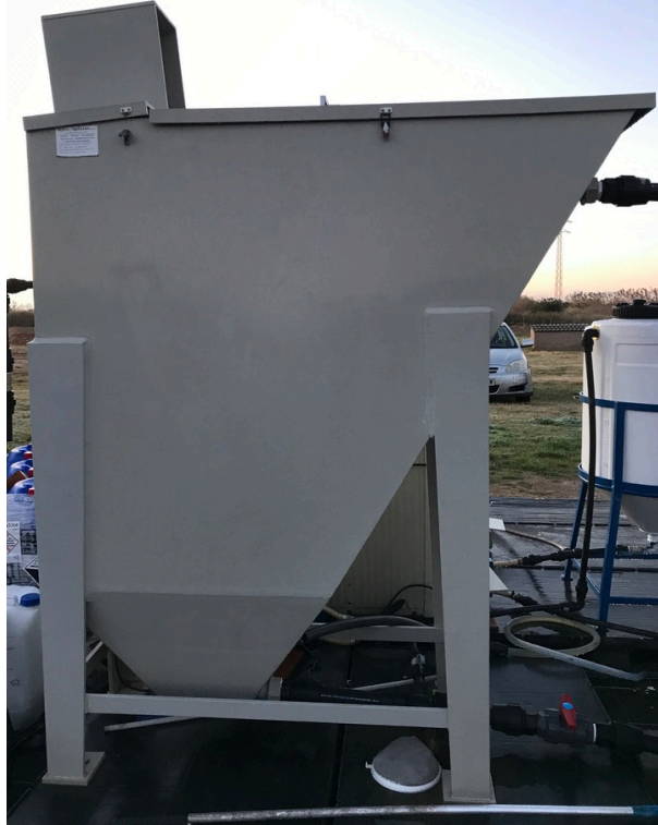
Figura 2.13 Sedimentador. La biomasa algal es recuperada con la adición de un floculante.
