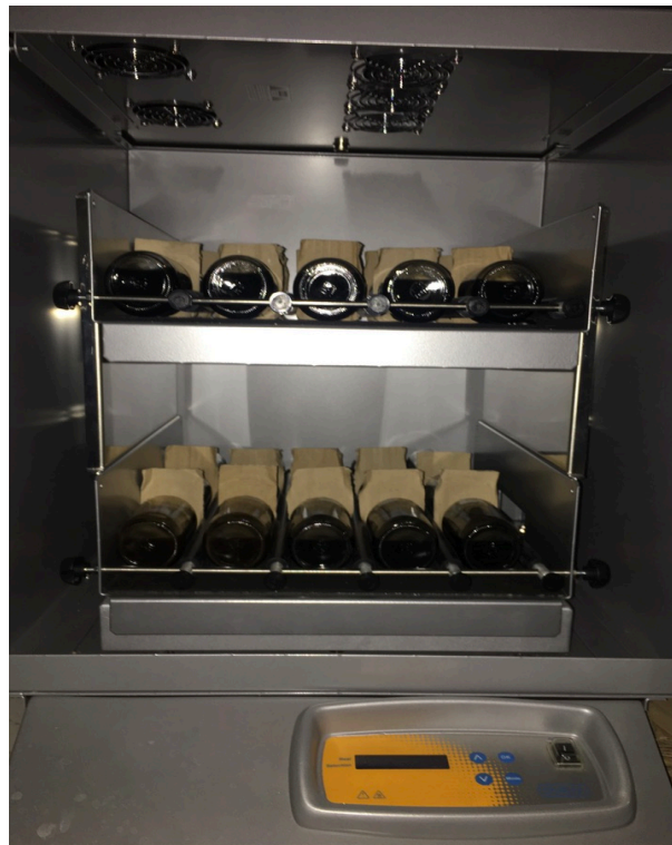
Figura 2.17 Incubadora con botellas. Las botellas fueron incubadas a 35°C, 85 rpm durante 40 días.
