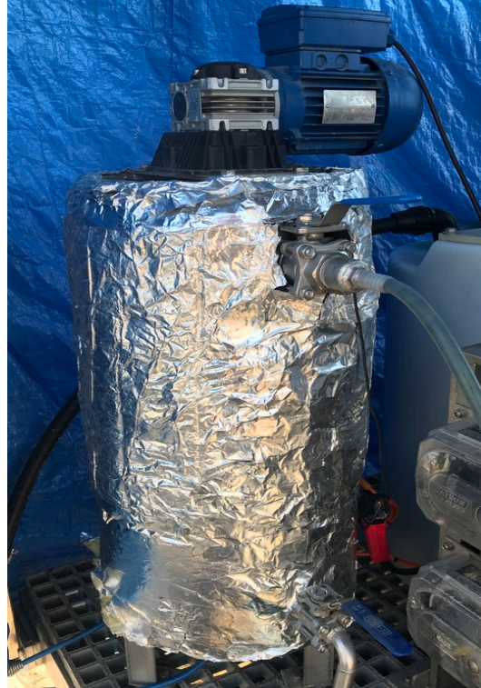
Figura 2.6 Tanque de hidrólisis. En éste tanque se lleva a cabo el pretratamiento térmico de la biomasa algal.
