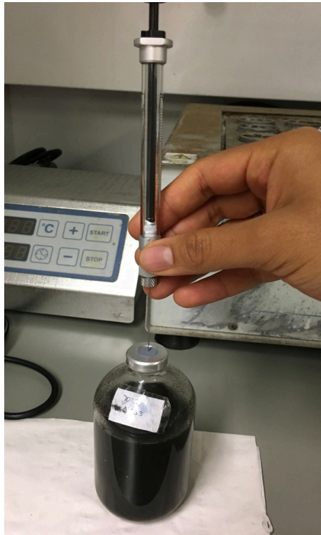
Figura 2.21 Jeringa de gases con la que se muestreaba el biogás producido en los ensayos BMP.
