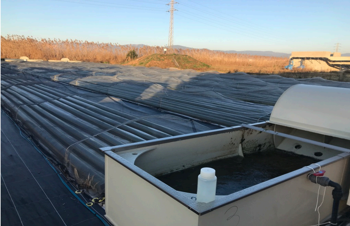
Figura 2.12 Fotobiorreactores tubulares horizontales semi-cerrados del parque experimental Agropolis.
