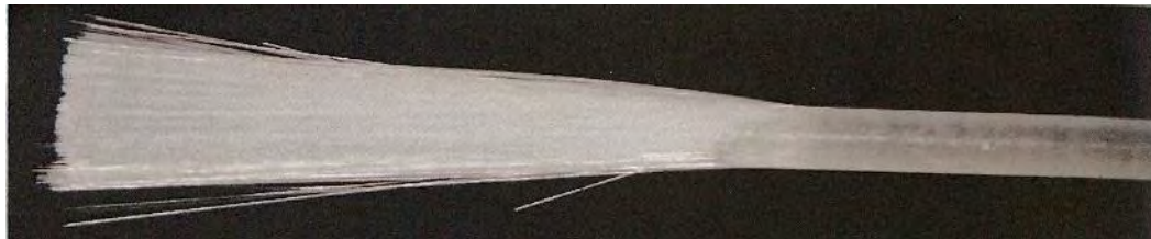
Fig. 13 Fabricación de poste de fibra de vidrio con una fase inmersa en resina epoxi y una fase de fibras dispuestas longitudinalmente.
