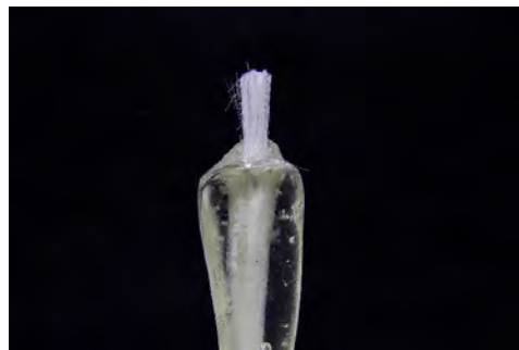
Fig. 48 Fotografía a 15x del poste cementado y corte de fibras accesorias. 13
