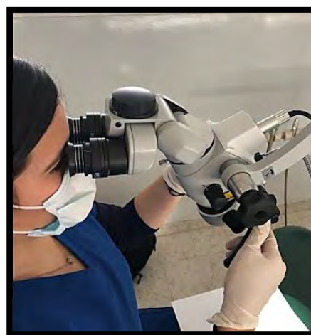
Figura 32. Ajustar la distancia interpupilar para obtener un solo punto. Fuente directa.
